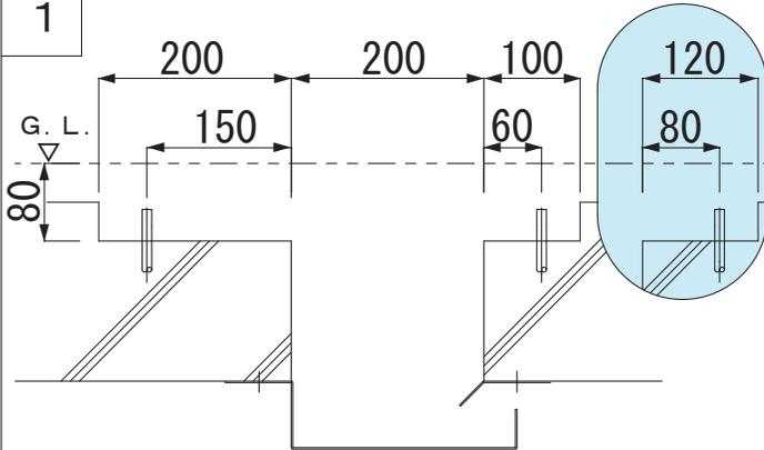
スラブをクリアランスの端部より受枠A側をJX-TE-Mは100mm、JX-TH-Mは120mm、受枠B側をJX-TE-M、JX-TH-M共に200mm、G. L. より80mmの深さで切り欠いておきます。φ10mmの丸棒を上図の寸法の位置にピッチ490mm間隔でたてておきます。
