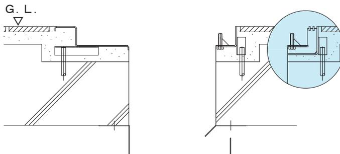
受枠のまわりにモルタルを充填し、その後、舗装面を仕上げます。
