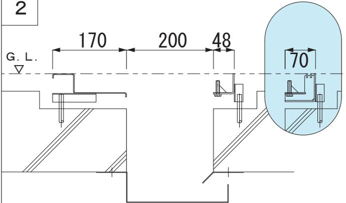
クリアランス端部より目地外寸法を受枠A側がJX-TE-Mを48mm、JX-TH-Mは70mm、受枠B側をJX-TE-M、JX-TH-M共に170mmになるようにそれぞれの受枠をセットし、受枠のアンカーを丸棒に溶接固定します。
