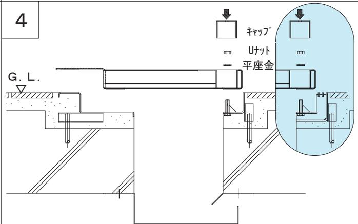
カバーを受枠Aにセットし、下から平座金、Uナットの順番でカバーを固定し、最後にキャップをかぶせます。Uナットの締め付けにはT形レンチ呼び13(別途)をご使用ください。
