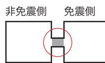
通路幅が同じでも、本体パネルのセンター部がスライド変形することにより、コンパクトな納まりに!!
