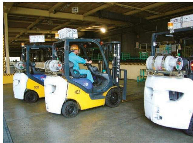
フォークリフトの場合は、日本建築学会発行の「建築物荷重指針・同解説」に基づき、前輪一輪に総重量の44%の負担荷重とし、移動荷重として衝撃係数1.5で設計します。フォークリフトで条件が異なる場合や、その他の特殊車両においても、同様の諸条件を提示いただき、弊社までご相談ください。
