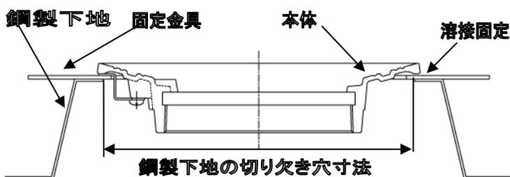
鋼製下地切り欠き穴寸法表
