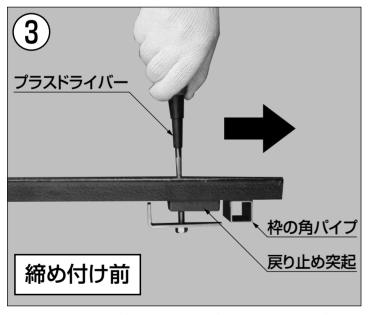
蓋を枠に載せ、プラスドライバーでトラスネジ頭部が戻り止め突起を超えるまでロック金具を角パイプ方向へスライドさせます。
