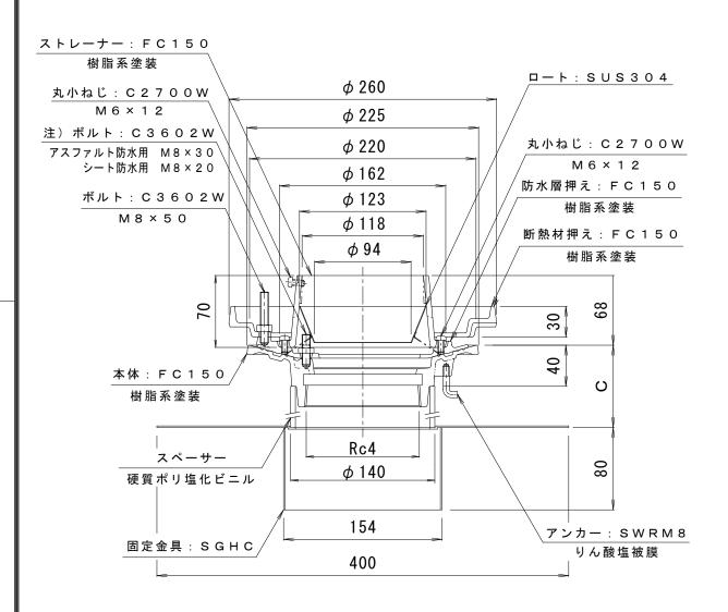
注)ボルト長さの適用防水層の厚さは、次の通りです。 アスファルト防水用の防水層厚さ=10~12mm シート防水用の防水層厚さ=3mm以下 ト記以外の場合は、防水層の厚さを御場示下され
