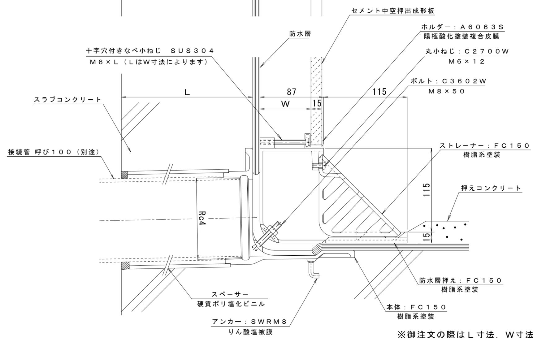
※御注文の際はL寸法, W寸法 (防水層と保護ボード間隔) をご指示ください。
