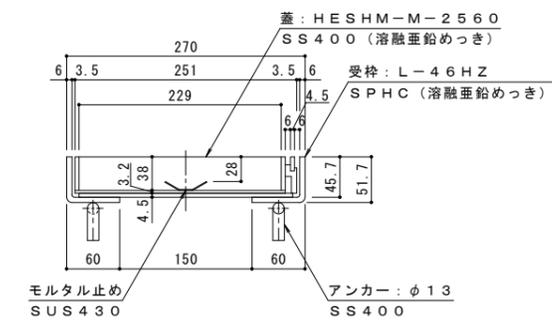
専用ハンドルを用いる、開閉が容易なタイプの蓋を用意しております。「把手穴付」とご指示ください。把手穴付の蓋の設置は、5枚に1枚程度が目安です。
