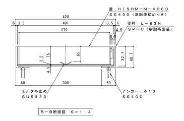
専用ハンドルを用いる、開閉が容易なタイプの蓋を用意しております。 「把手穴付」とご指示ください。 把手穴付の蓋の設置は、5枚に1枚程度が目安です。
