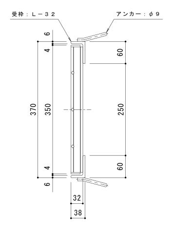
世様 ※適用荷重:T-6(側溝用)
