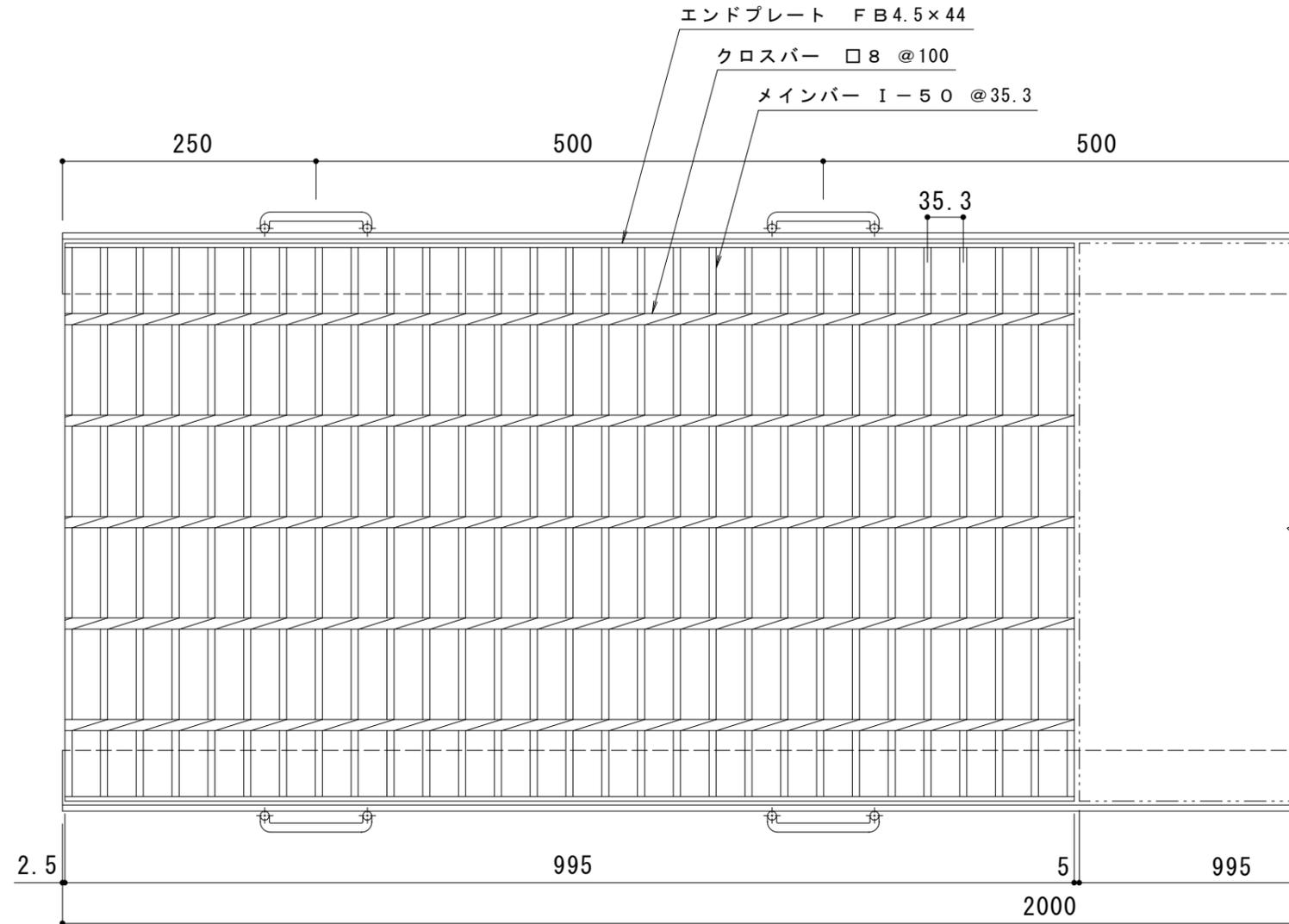
仕様 ※適用荷重：T-6（横断溝・側溝用）
