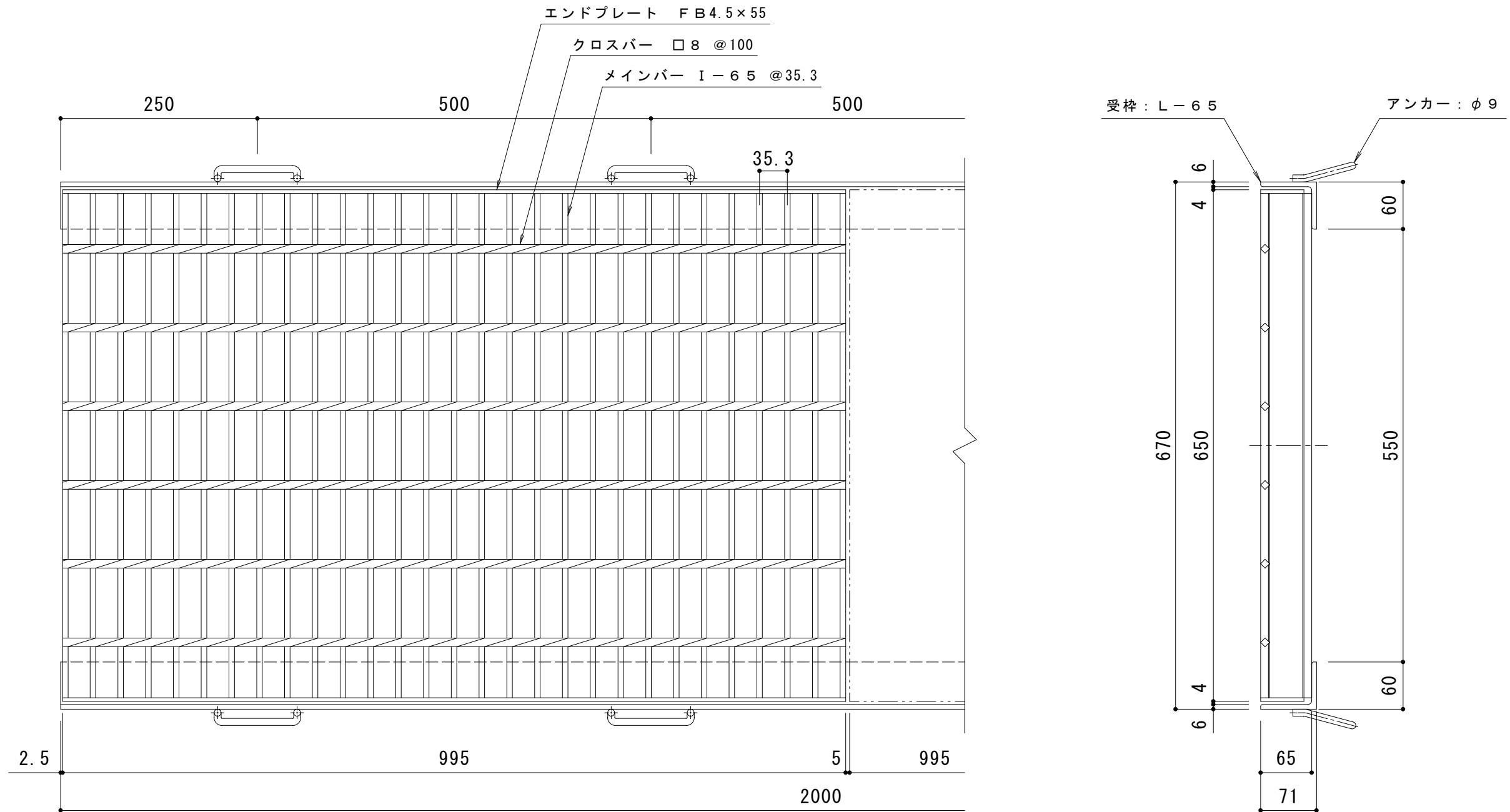
仕様 ※適用荷重：T-14（側溝用）
