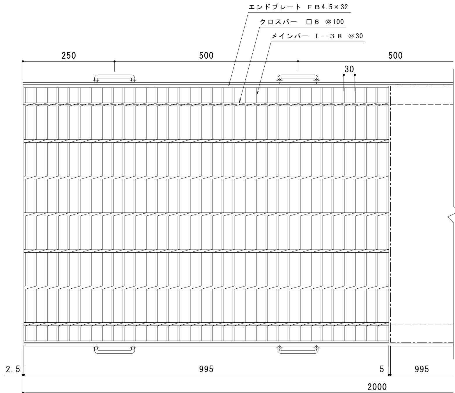
仕様 ※適用荷重：T-2（側溝用）
