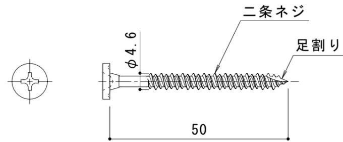
仕口ダンパー専用木ネジ 材質：SUS410 処理：高耐食防錆処理（黒色）
