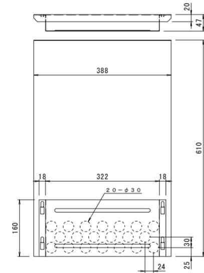
可動式隔板詳細図 S=1:5
