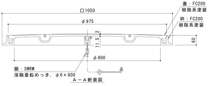
マンホール鉄蓋 水封形(防臭形)角枠 鎖付
