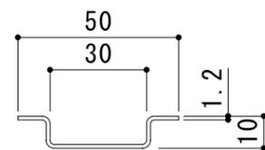
モルタル止め補強材詳細図 S = 1 : 2
