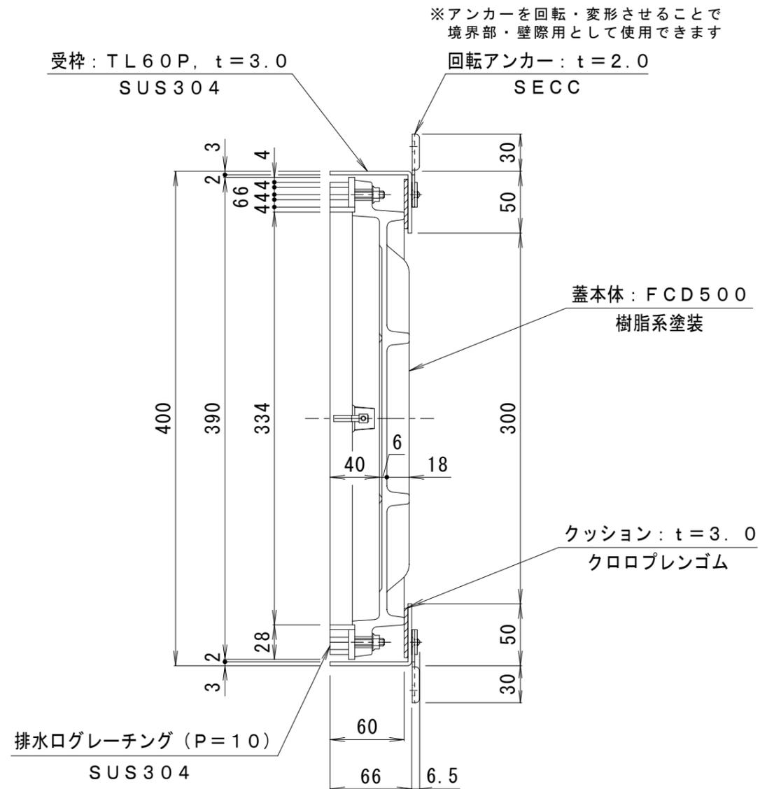
※アンカーを回転・変形させることで境界部・壁際用として使用できます
