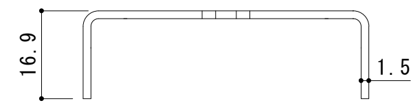
ボルトキャップDC-1-20詳細図 S = 1 : 1
