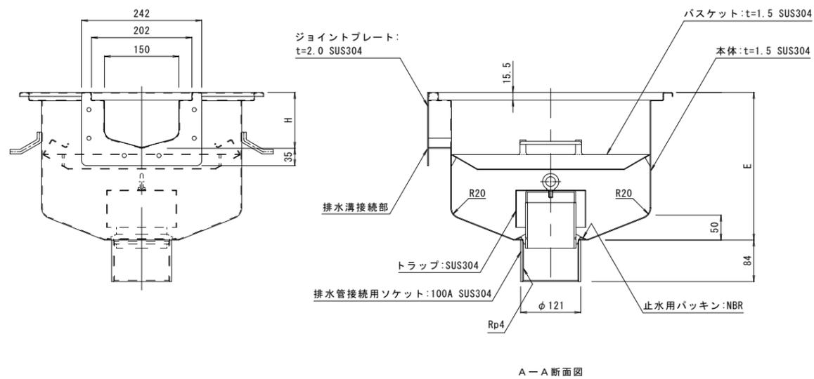
寸法表〈接続排水溝・柵高さ〉 [単位: mm]
