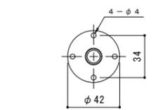
固定プレート平面図 S=1:2
