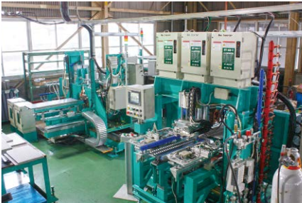
ステンレス製グレーチング生産設備
