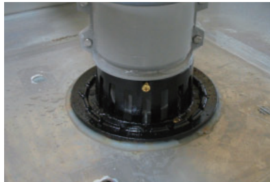
噴き出し無(弊社排水試験装置による)
