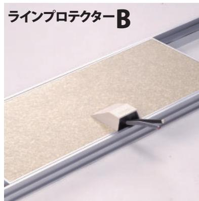
屋内配線の損傷事故の多くは配線取出口に起因するものです。金属蓋との摩擦によるケーブル線の損傷を防ぐとともに、機器の位置移動・増設に即応できるラインプロテクター（配線取出用キャップ）を2種類用意しました。ラインプロテクターは、ケーブルを機器に結線したままでも、点検できる構造になっています。
