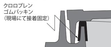
パッキンを水封形のふたまたは枠に装着し、ふたの自重によって圧着し、簡易密閉にした構造です。(パッキンは必ず現場にて接着剤等で固定してください。)
