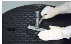
④ 蓋中央の小蓋を取り付けます。時計まわりの方向に回転して、確実に締め付けてください。
