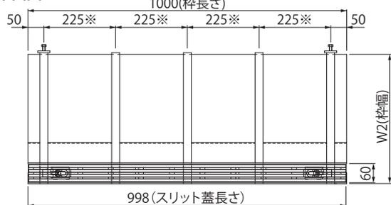
※枠の補強梁は、T-2仕様の場合4本、取付ピッチ300mmとなります。
