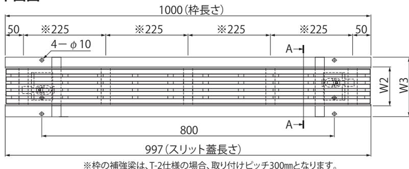
※枠の補強梁は、T-2仕様の場合、取り付けピッチ300mmとなります。
