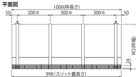
※枠の補強梁は、T-14仕様の場合5本、取付ピッチ225mmとなります。
