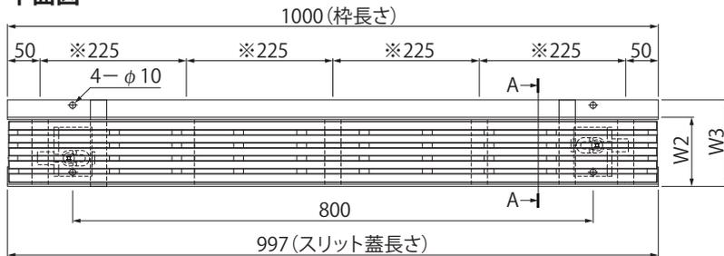
※枠の補強梁は、T-2仕様の場合、取り付けピッチ300mmとなります。
