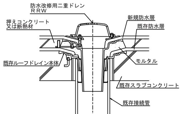
⑥ 新規防水工事を行い、防水層押え、ストレーナーを取り付け、施工完了です。
