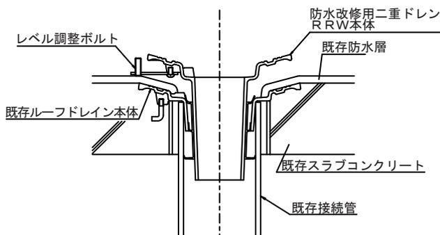
③ 押えコンクリートの厚みまたは、断熱材の厚みに合わせ、レベル調整ボルトでRRW本体の高さを調整します。
