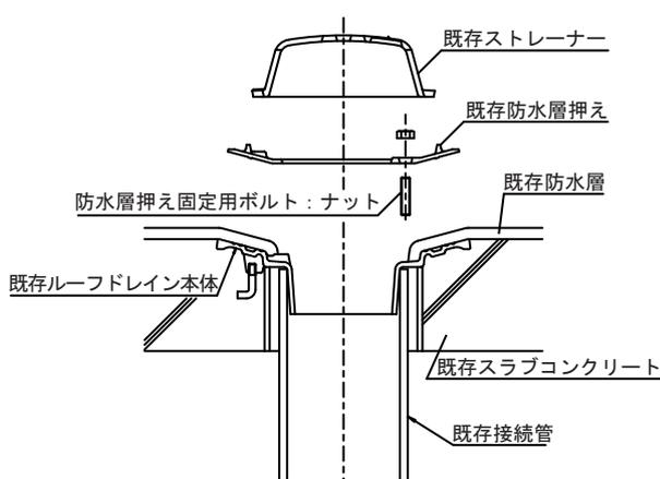
① 既存ルーフドレインのストレーナー、防水層押え、防水層押え用ボルトを外します。
