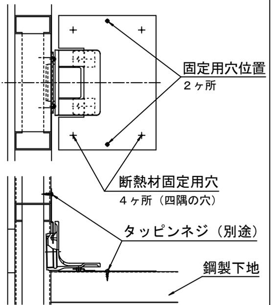
3. 断熱材、塩ビ被覆鋼板を固定金具Bに載せ、付属の皿タッピンネジで固定します。
