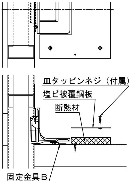
4. 屋根断熱材（及びパラペット断熱材）敷き込み後、防水工事を行います。防水工事後、防水層押え、ストレーナーを組立て取り付け完了です。
