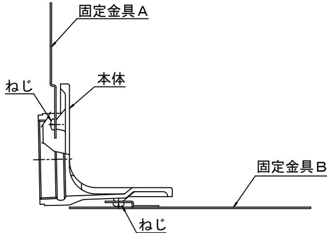
2. 組立てたルーフトレインを鋼製下地に載せ、タッピンネジ（別途）でパラペット立ち上がり面及び鋼製下地（各2ヶ所）に固定します。
