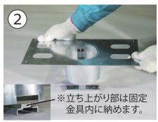
固定金具を、位置決めプレートに載せます。この時、固定金具下部切り欠きに、位置決めプレートが嵌まるように、 載せてください。
