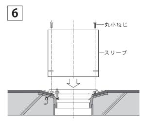
スリーブを防水層押えに丸小ねじ2本 で取り付けます。
