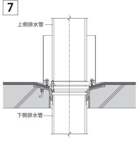
上側および下側の排水管を取り付けます。排水管取り付け時の注意事項は、4ページを御参照ください。
