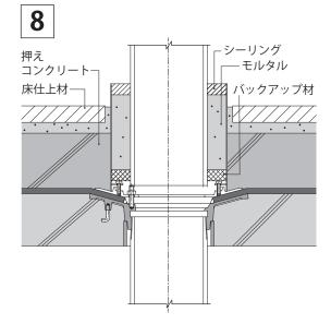
上側排水管とスリーブの隙間にモルタル等を詰め、上端部にシーリングを施します。押えコンクリートおよび床仕上材を施工し完了です。
