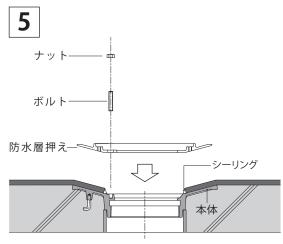
コンクリートに硬化後、防水工事を行い、防水層押えをボルト・ナットで3ヵ所、本体に固定します。防水層端部はシーリングを施します。
