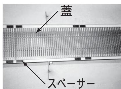
※サニタリートラフの変形を防ぐため、蓋をはめた状態でコンクリートを打設してください。この時、蓋とサニタリートラフの目地の隙間に付属のスペーザーを必ず入れてください。
