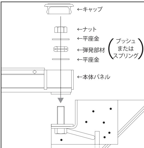
図③ ナット締め付け目安
