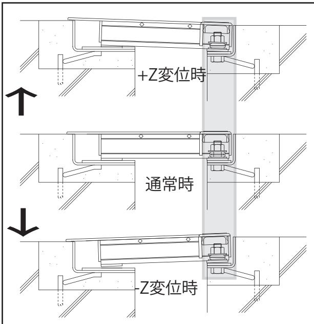
EXジョイント人工地盤用本体パネルは構造上、上下方向 (+Z方向および-Z方向) の変位にも追従します (図①参照)。
