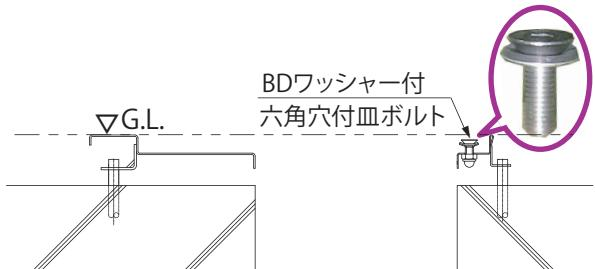
受柱 A、B をセットし、受柱のアンカーを差筋に溶接します。
