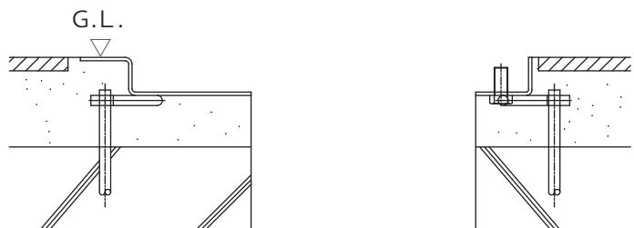
受枠のまわりにモルタルを充填します。その後、舗装面を仕上げます。
