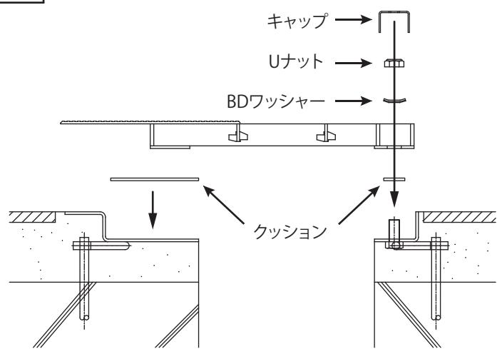
受枠の表面の汚れ、ゴミなどを清掃後クッション材をまっすぐな状態で貼り付けます。本体パネルをセットし、下からBDワッシャー、Uナットの順で連結し、最後にステンレスキャップを被せます。
