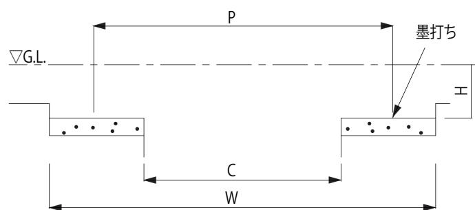
枠フレーム取付面に、モルタル金ゴテ仕上げを行います。
