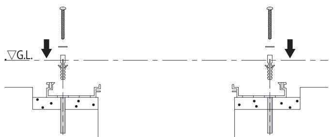
枠フレームの取付穴にあわせて、スラブにφ8、深さ60mmの下穴をあけます。
