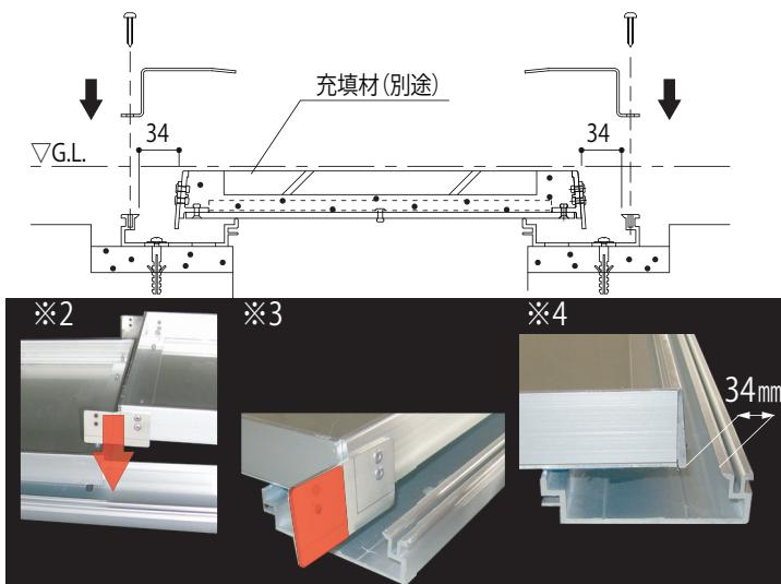
充填材を貼り込んだ本体パネルを枠フレームに載せます。本体パネルと枠フレームの両端のすきまは34mmずつあけるようにします(※4)。
