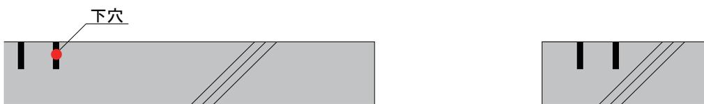
図面に従いスラブに墨出し、アンカーボルト用の下穴を開けます。
