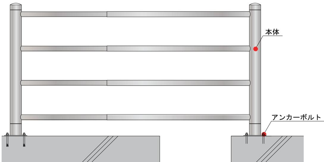
本体両端の支柱レベルを調整し、アンカーボルトでスラブに固定します。
