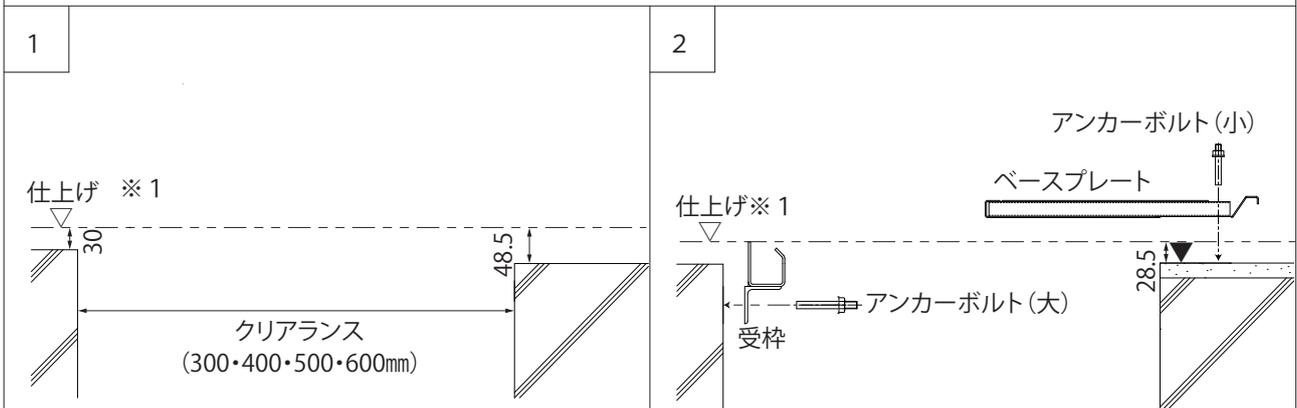
施工図に従いスラブを仕上げます。
