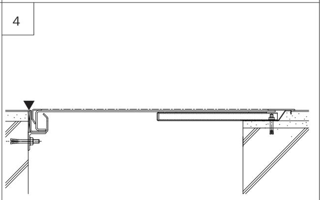
ベースプレートと受枠のまわりにモルタルを充填します。
