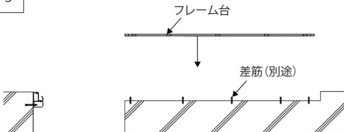
図面にて寸法確認を行い、フレーム台を溶接固定します。
