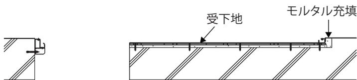
図面にて寸法確認を行い、受下地をフレーム台に溶接固定します。
