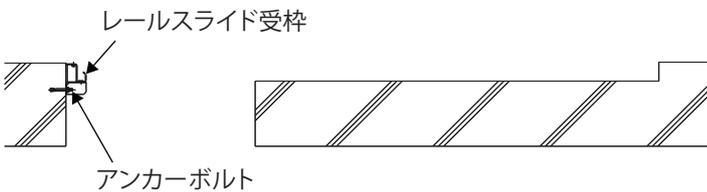
図面にて寸法確認を行い、レールスライド受枠をアンカーボルトにて固定します。
