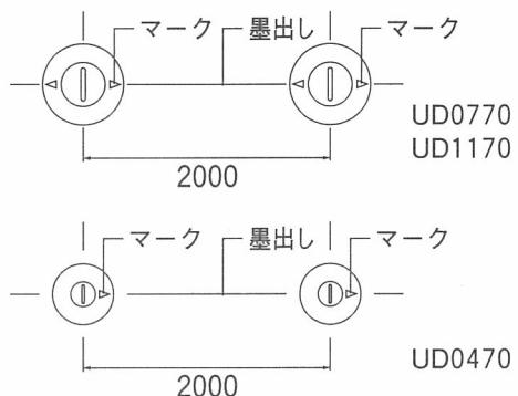
③墨出しに化粧プレートの△マークを合わせて、車止めを設置します。この時、車止めの垂直度を確認してください。
