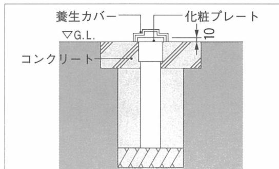
⑤車止めの上部にコンクリートを打設し施工完了。この時、化粧プレートがコンクリートに埋まらないようにしてください。また、養生カバーは、コンクリートが固まるまで取り外さないでください。
