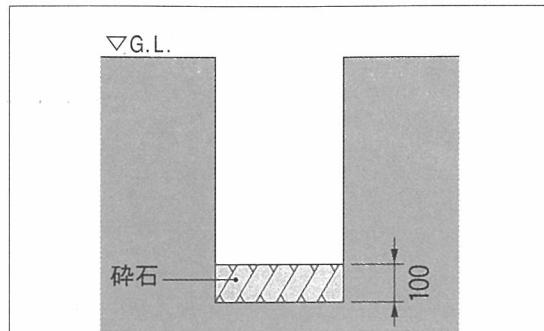
②穴の底部に碎石を入れ、転圧し平坦にしてください。(製品の沈下防止及び埋設管内の水はけをよくするため。)
