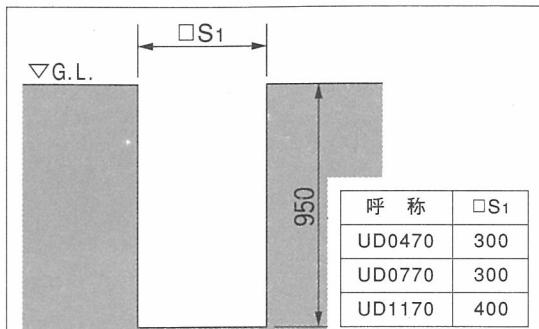
①車止めの設置場所に□S1、深さ950mmの穴を掘ります。
