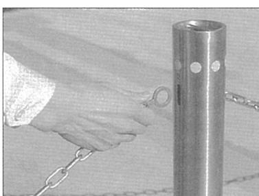
②隣接する車止めの鎖固定穴にリングを挿入し、リングを90°回転して仮止めの状態とします。
