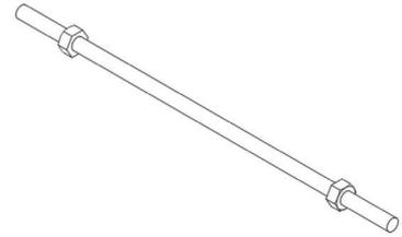
1 支柱にアンカーボルトを組み付け、支柱とアーチパイプを六角ボルトで固定します。
