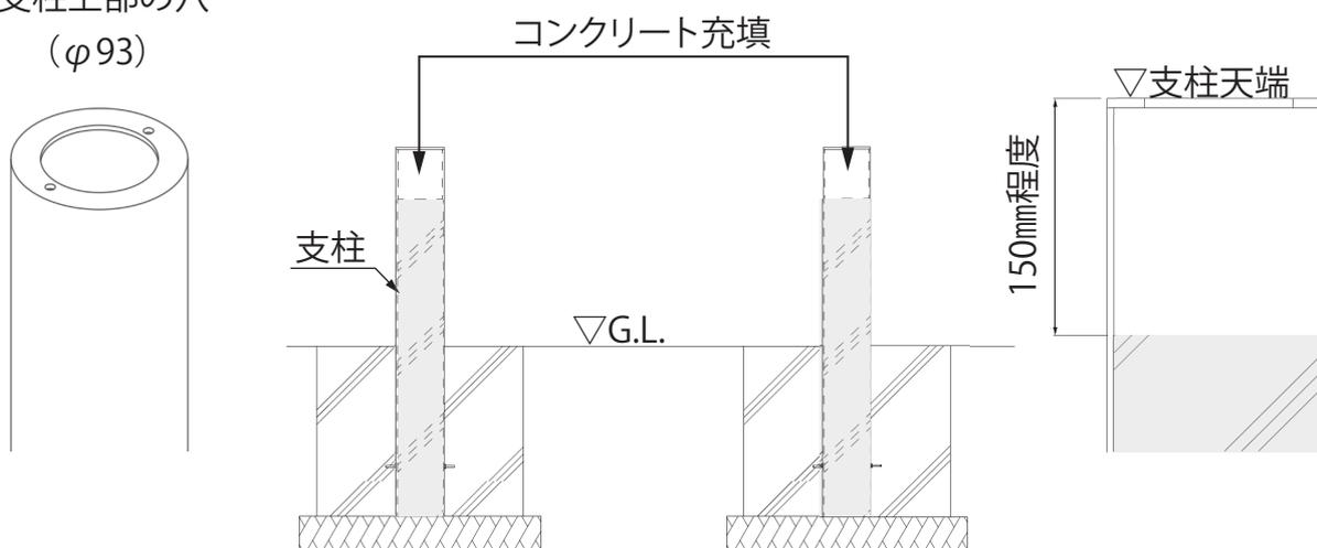
※コンクリートの充填高さは、支柱天端より150mm程度としてください。
