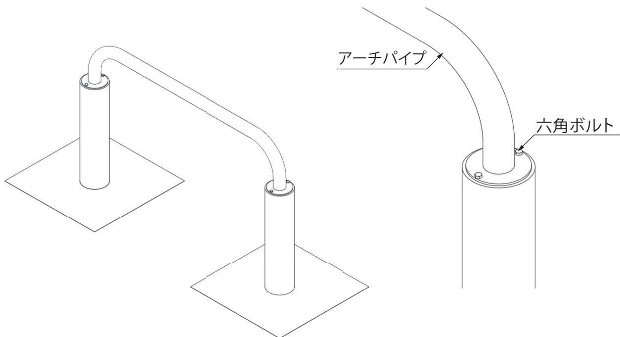
6 充填コンクリートが硬化するまで養生し、施工完了です。
