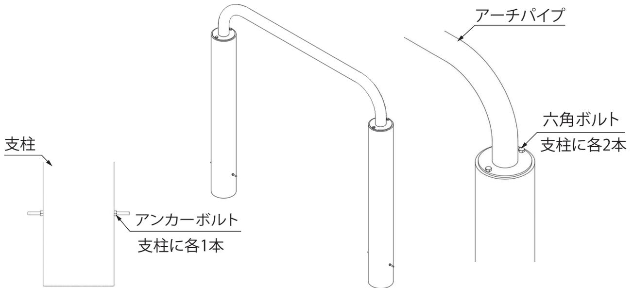
2 製品を設置場所へ置き、基礎コンクリートを打設して支柱を固定します。
