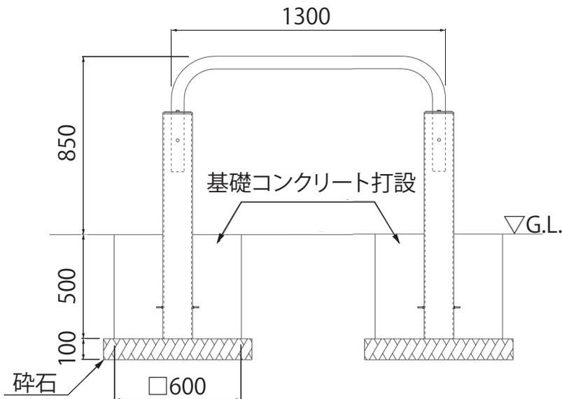
3 基礎コンクリート硬化後、六角ボルトとアーチパイプを外します。
