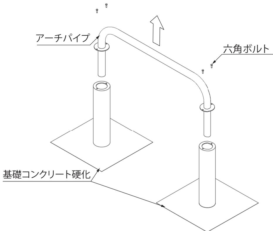
4 支柱上部の穴からコンクリートを充填します。
