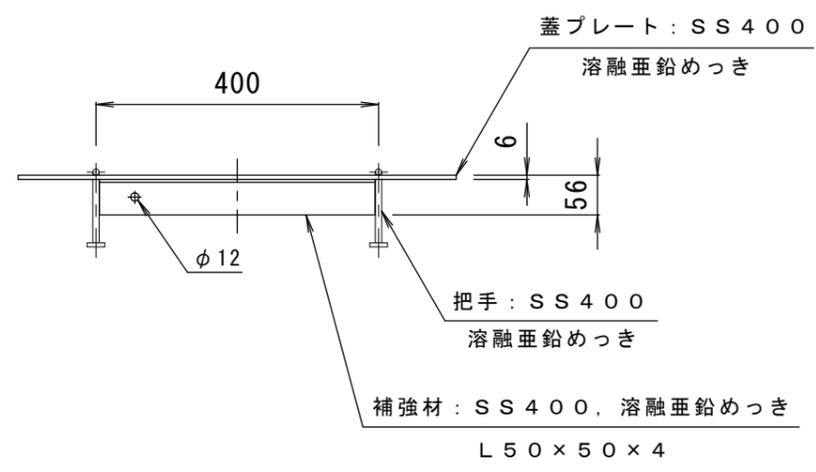
※NEXCO 機械電気通信設備標準図集 V-63 該当品
