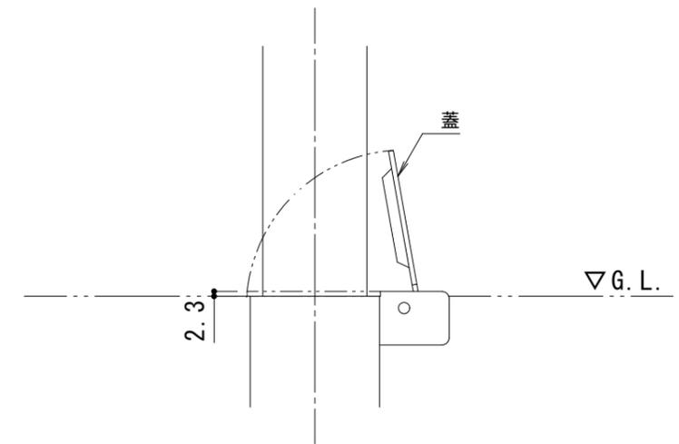
埋設管蓋部 詳細図 S = 1 : 3
