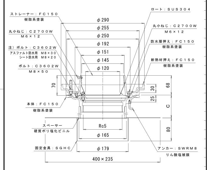
注)ボルト長さの適用防水層の厚さは、次の通りです。 アスファルト防水用の防水層厚さ=10~12mm シート防水用の防水層厚さ=3mm以下 ト記以外の提合は、防水層の厚さを御塩マ下され
