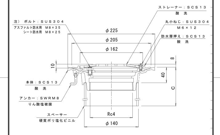
注)ボルト長さの適用防水層の厚さは、次の通りです。 アスファルト防水用の防水層厚さ=10~12mm シート防水用の防水層厚さ=3mm以下
