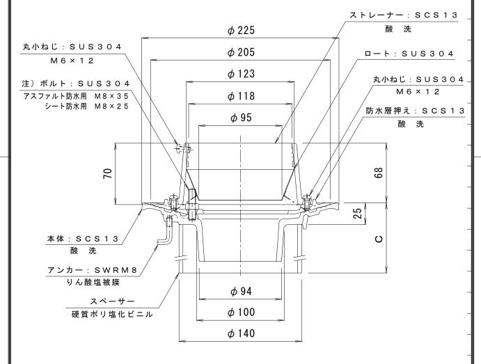
注)ボルト長さの適用防水層の厚さは、次の通りです。 アスファルト防水用の防水層厚さ=10~12mm シート 防水用の防水層厚さ=3mm以下 ※ ご注文の際はC寸法をご指示ください。 上記以外の場合は、防水層の厚さを御指示下さい。
