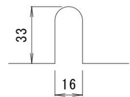
アンカーボルト用切欠部詳細図 S = 1 : 2
