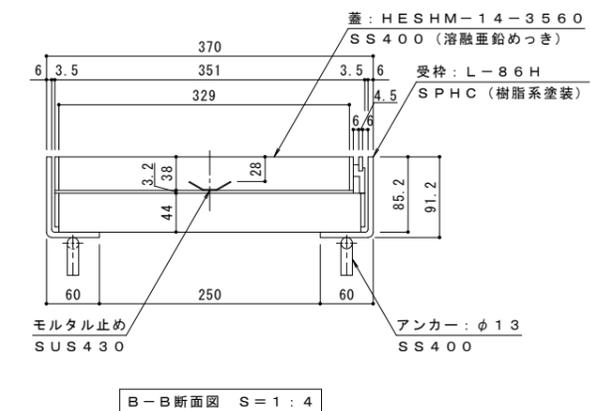
専用ハンドルを用いる、開閉が容易なタイプの蓋を用意しております。「把手穴付」とご指示ください。把手穴付の蓋の設置は、5枚に1枚程度が目安です。
