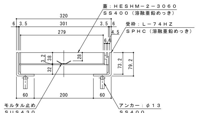
専用ハンドルを用いる、開閉が容易なタイプの蓋を用意しております。
