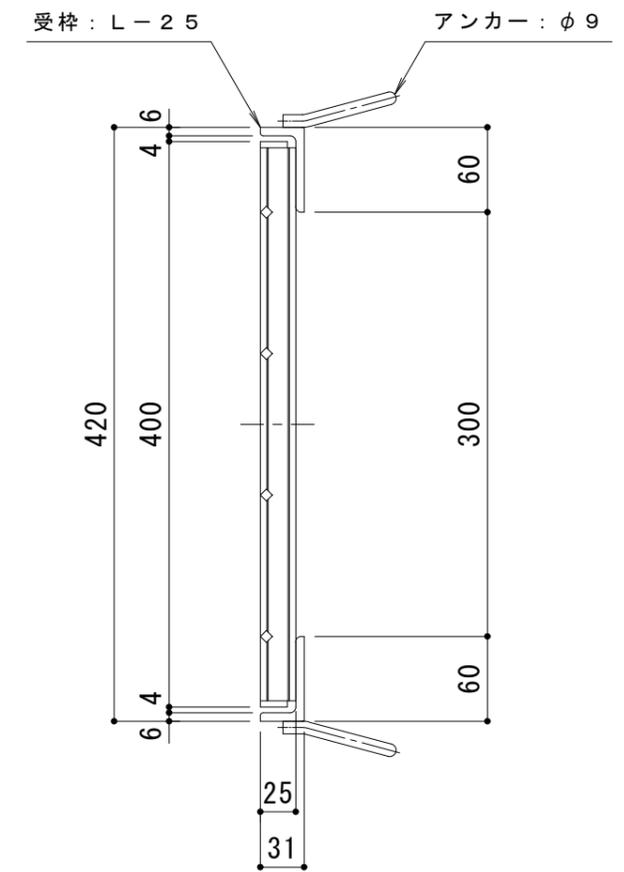
**仕様** ※適用荷重：T-2（側溝用）
