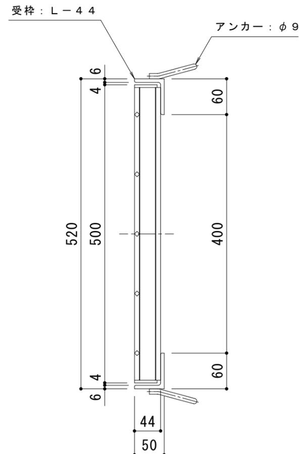
**仕様** ※適用荷重：T-6（側溝用）
